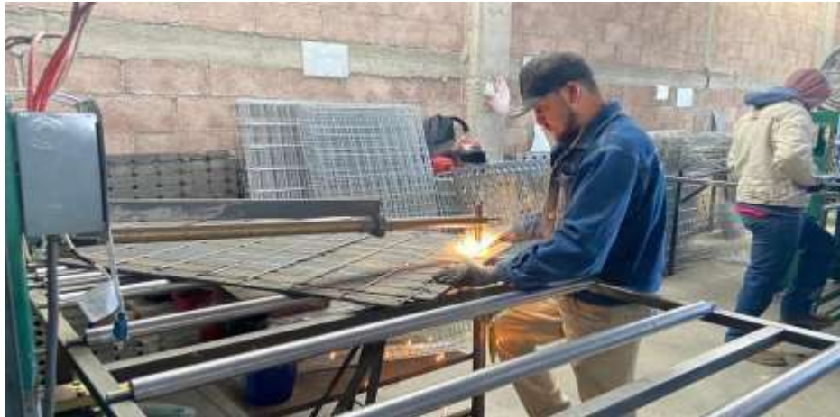
Ilustración 18. Proceso de soldadura en punteadora.
