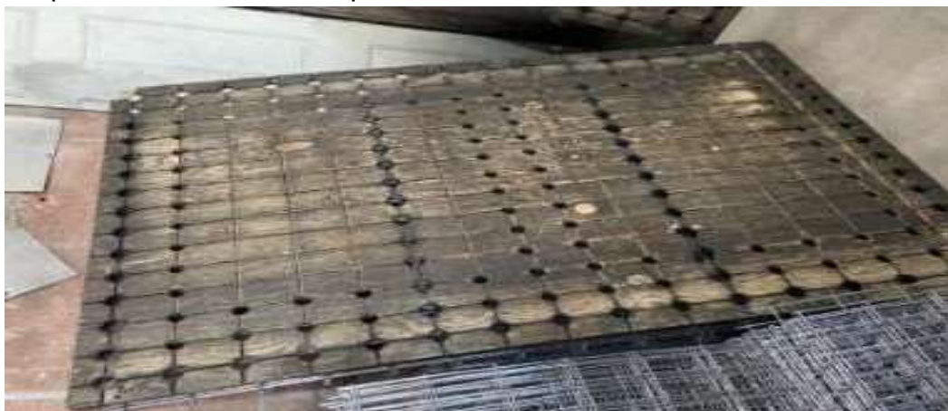
Ilustración 16 molde para empotrar el alambre de 1.5 x .75 metros
